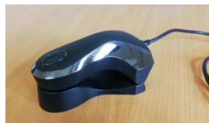
Abb. 1. Spektrophotometrische OligoCheck-Sensoreinheit auf ihrem Ständer. Oben: Schaltfläche zum Einleiten des Scanvorgangs; unten (nicht sichtbar, im Ständer versteckt): Sensorkopf.
